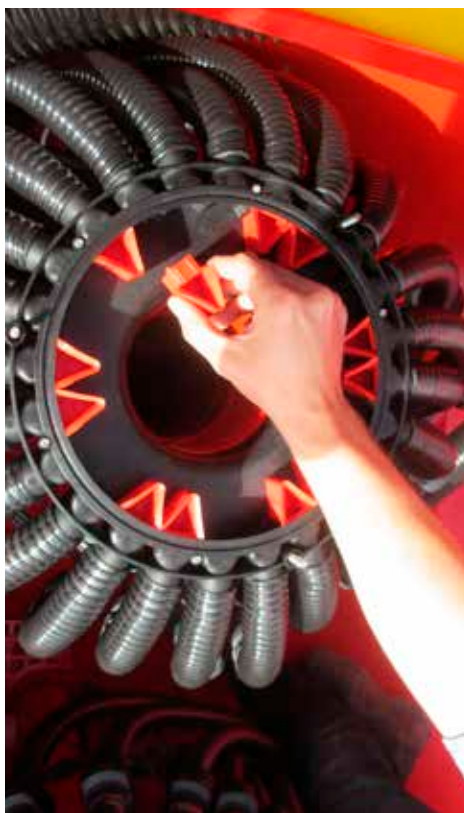
Några enkla handgrepp med pluggar i utloppen konverterar enkelt en Rapid till radsåmaskin. – Att plugga eller inte plugga – det är frågan, travestrar David det berömda uttrycket i Shakespeares Hamlet när han väljer mellan att så med breda eller smala radavstånd.
