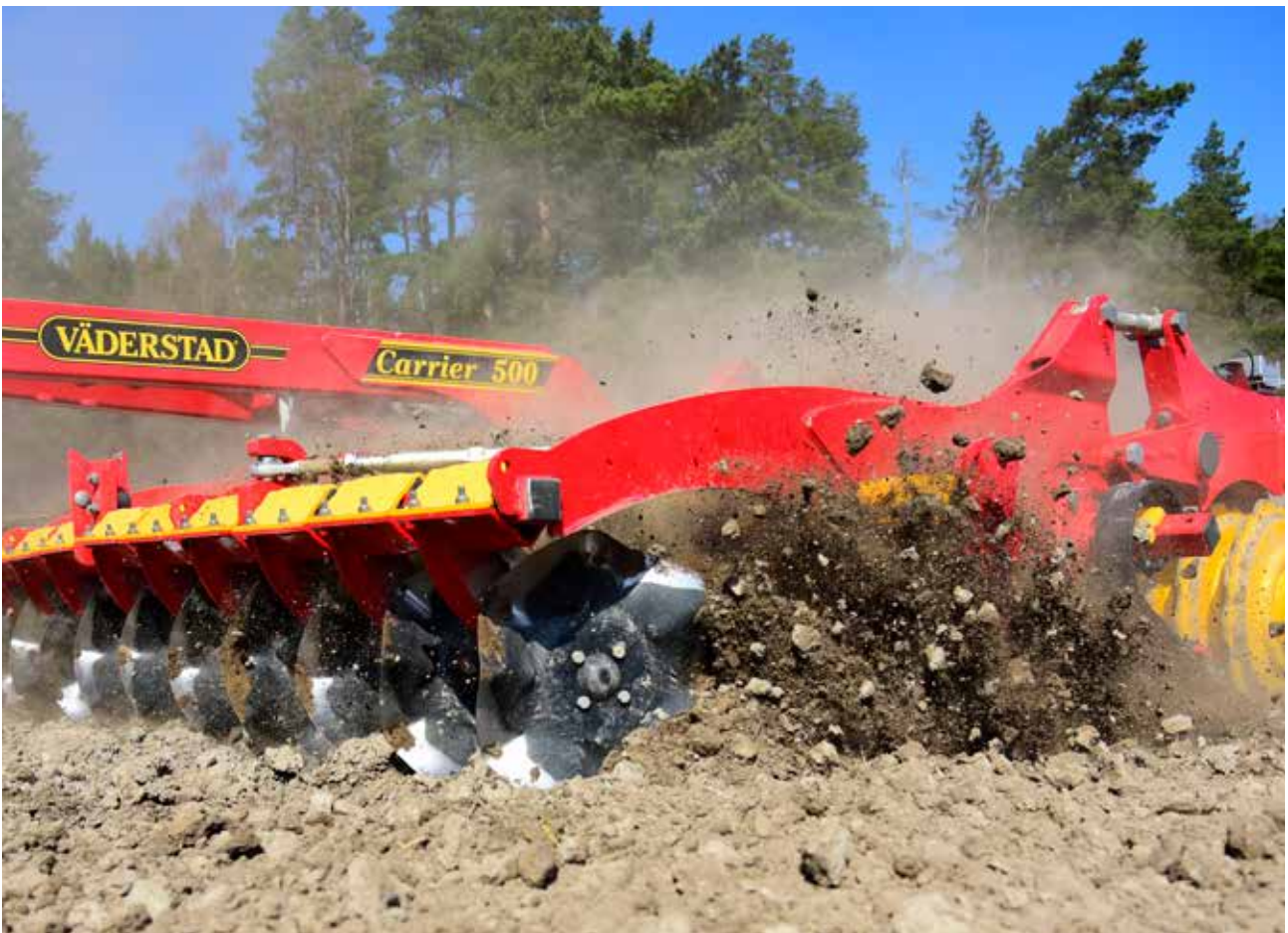
Arbetet som CrossCutter Disc utför går närmast att jämföra med det som en jordfräs åstadkommer.
