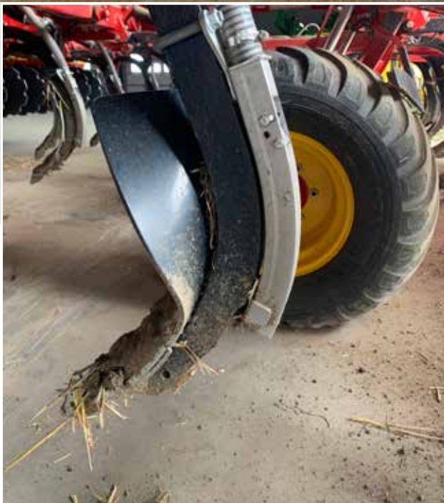
Såröret mynnar bakom kultivatorpinnen på TopDown.
