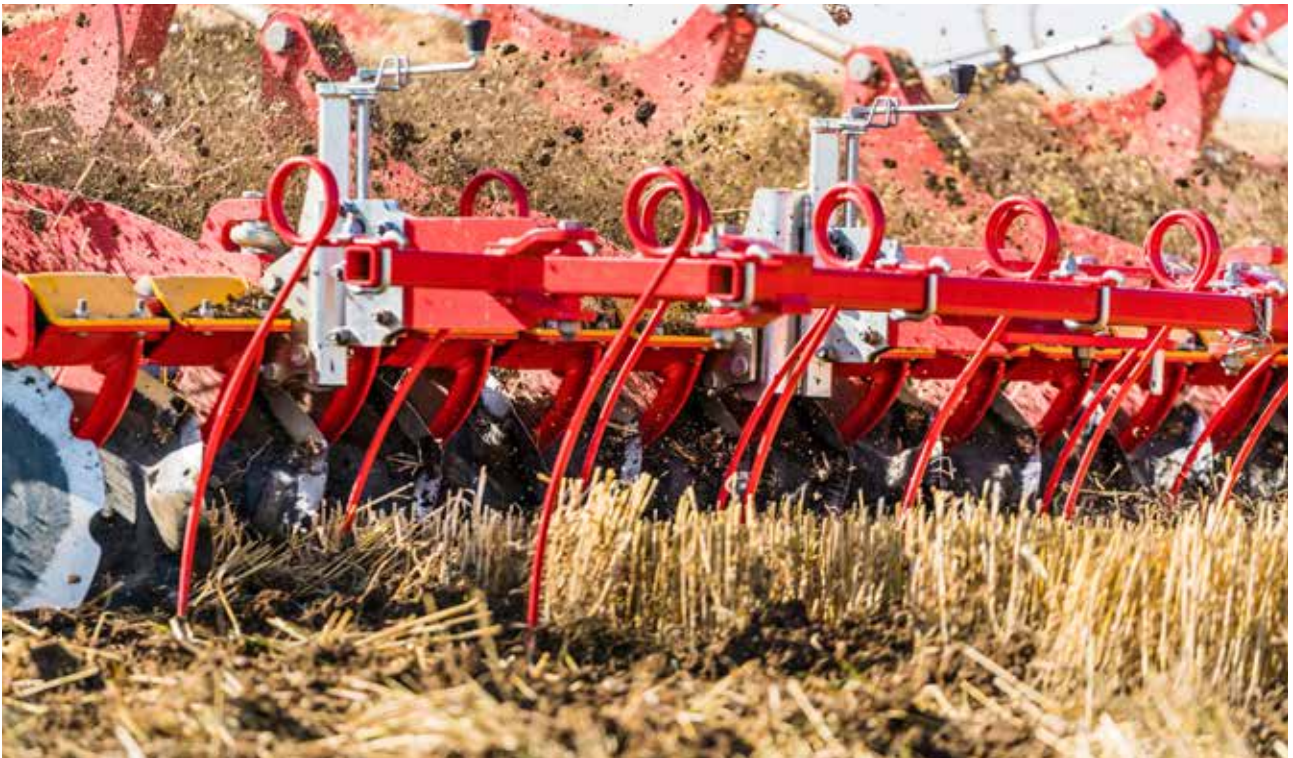
En halmharv längst fram på Carrier sprider ut halm och skörderester jämnt över fälten.
