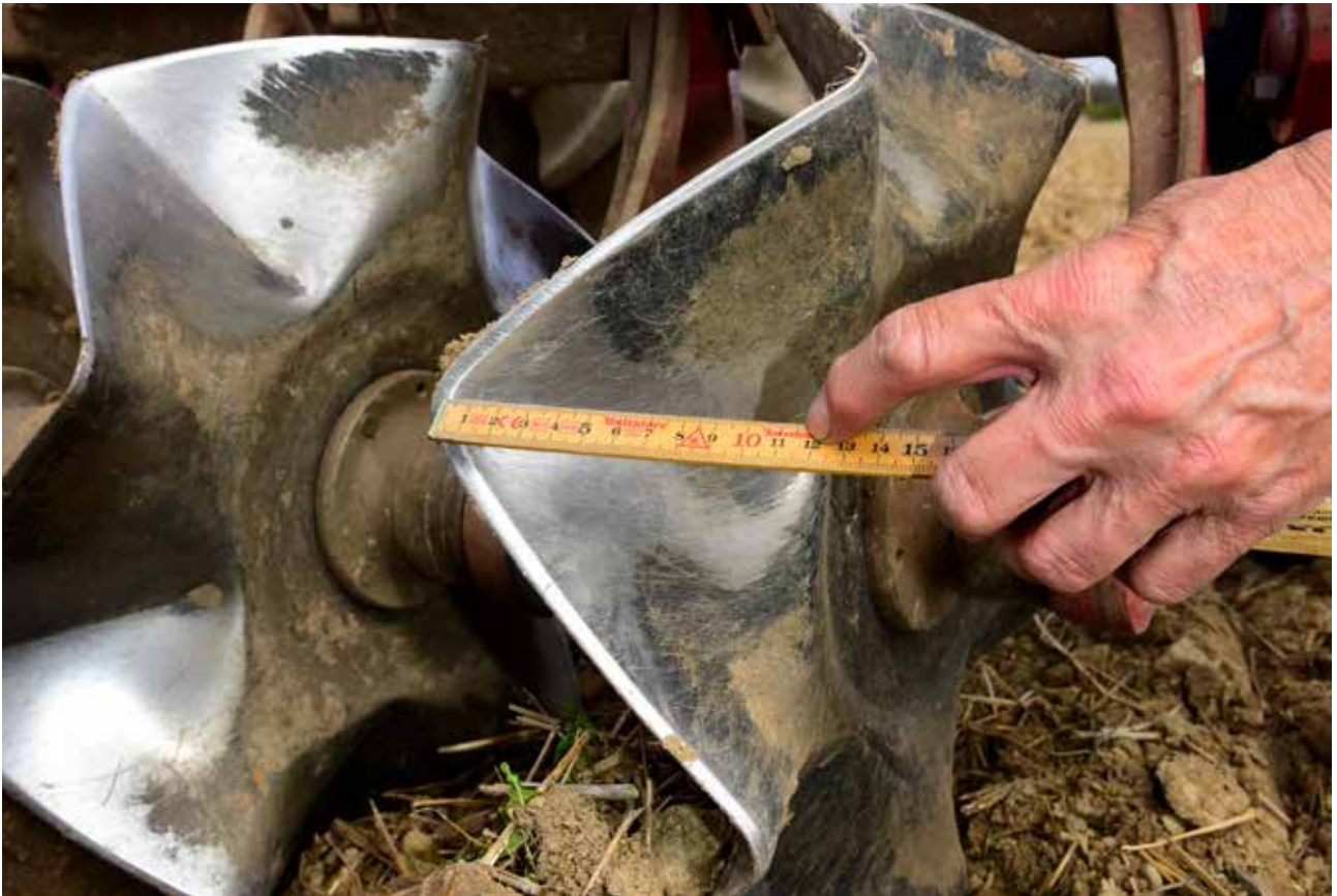
Anläggningsytan på tallriken CrossCutter Disc är 11,5 cm.
