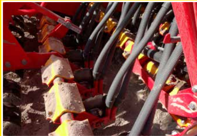
EkoRapiden har dubbla utlopp och dubbelbill. Det gör att den klarar att mata ut dubbelt så mycket gödsel som annars hade varit fallet. Perfekt för ekoodlingen där halterna av växtnäring är lägre och volymerna som ska matas ut högre.
