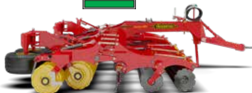
Hydraulisk parallellinställning från hytten
