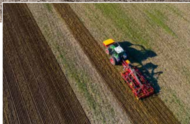
En TopDown utrustad med BioDrill utför också en form av direktsådd.
