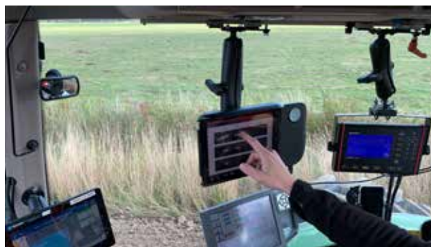
På Spirit-såmaskinen styrs både MAP-gödsling och utsädesgiva till höstvetet utifrån markkartan. Till vårsåden används en rak NPK-giva, men utsädesmängden styrs efter markkartans värden.
