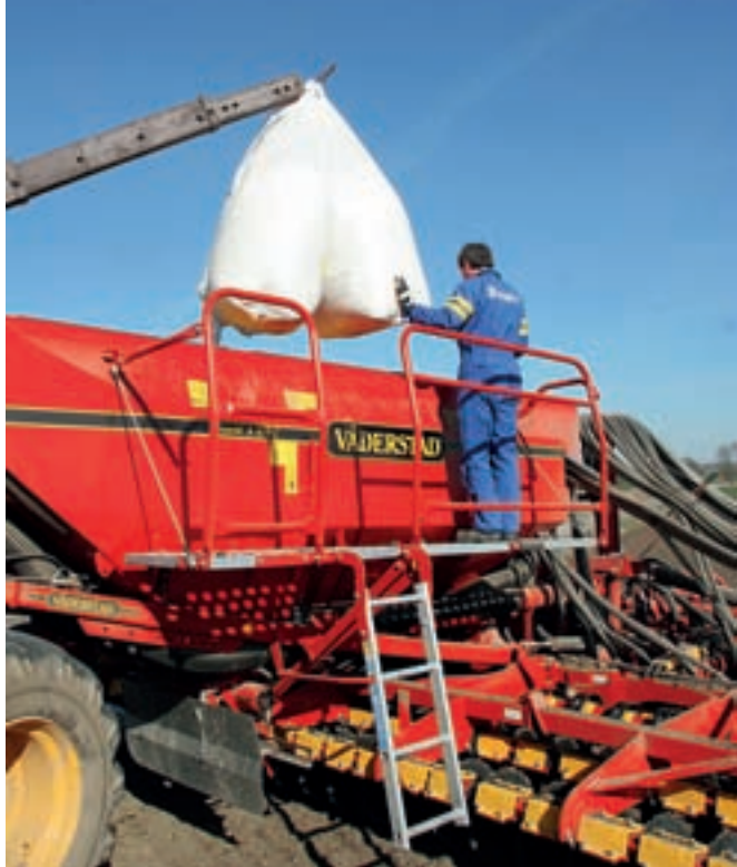
На пневматичних сівалках RAPID бункер ємністю 6 000 літрів легко завантажувати добривами з біз-безів
