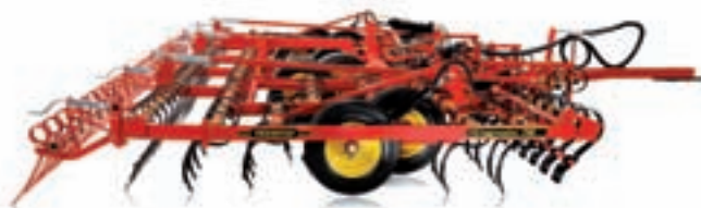
Універсальний штригельний культиватор NZ: 5, 6, 7, 8, 9, 10 м
