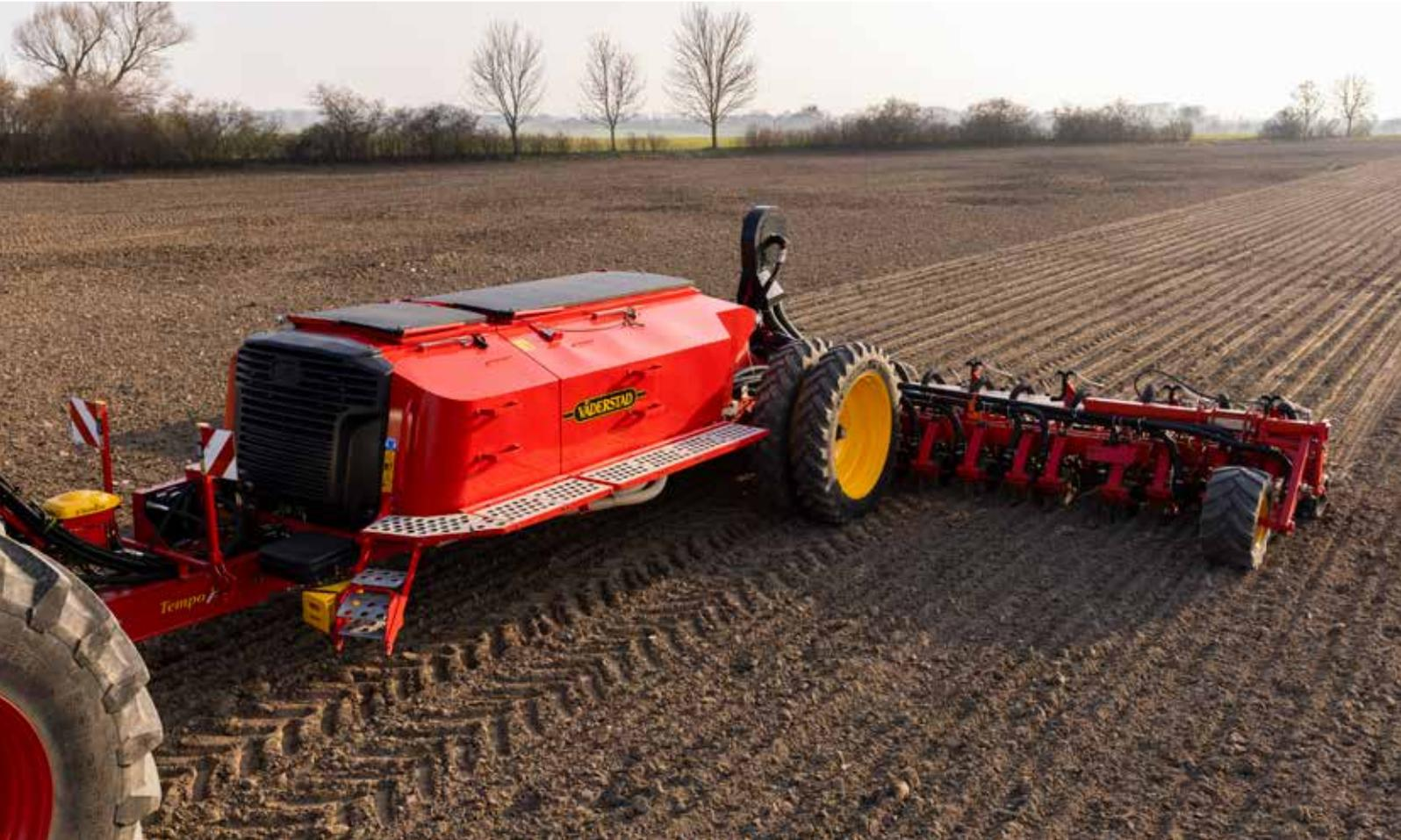
Die Entwicklung der Tempo L Central Fill fand mit dem klaren Ziel statt, die Schlagkraft und die Ablagegenauigkeit zu maximieren. Das Central-Fill-System arbeitet mit Überdruck, um die hochpräzisen Tempo-Säherzen an den Reiheneinheiten mit Saatgut zu versorgen. Nachdem das Saatgut zu den Säherzen transportiert wurde, sorgt die patentierte PowerShoot-Technologie für eine ausgezeichnete Ablagepräzision bei hoher Geschwindigkeit.
