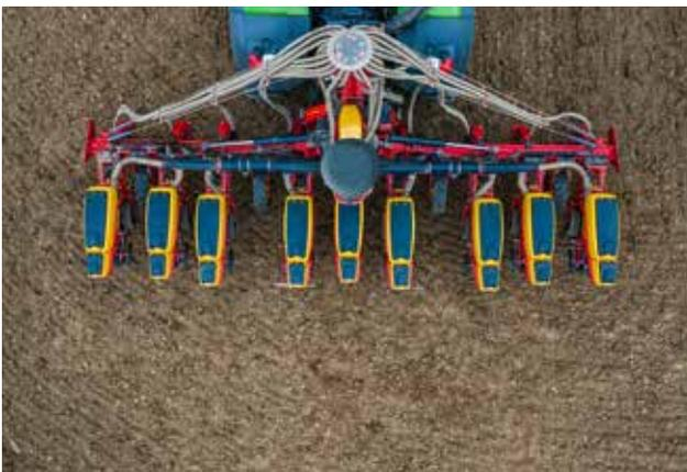
*WideLining passt den Reihenabstand automatisch an die Fahrgassen des Gülleausbringers an, ohne die Anzahl der auf dem Feld ausgebrachten Samen zu verringern.*
