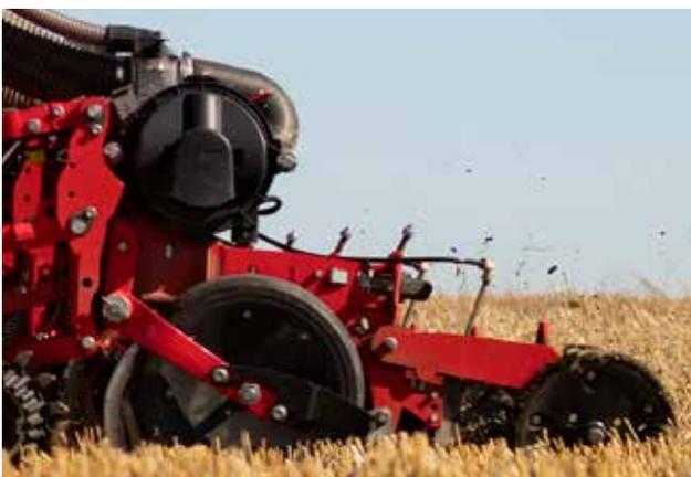
*Die Tempo L mit zentraler Saatgutbefüllung profitiert vom gleichen PowerShoot-Dosiersystem wie alle Tempo Einzelkornsämaschinen, was eine exakte Präzision bei sehr hoher Geschwindigkeit gewährleistet.*
