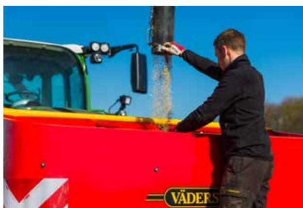
*Das abfallende Tankdesign gibt dem Fahrer eine gute Sicht nach vorne. Die breite Öffnung und die eingebaute Trittstufe erleichtern die Befüllung.*
