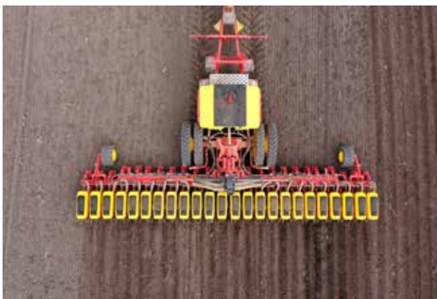
Ein 3000-Liter-Behälter für Granulatdünger ist als Ergänzung zum 5000-Liter-Behälter bei den Modellen mit Spitzenkapazität erhältlich. Darüber hinaus kann die Tempo L mit einem 2000-Liter-Behälter für die Flüssigdüngerausgabe ausgestattet werden.
