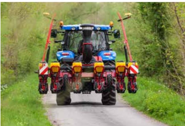
*Tempo T ist erhältlich mit Transportbreiten zwischen 3,3 m und 3,5 m. Dies sorgt für einen kleinen Kurvenradius und komfortablen Transport.*
