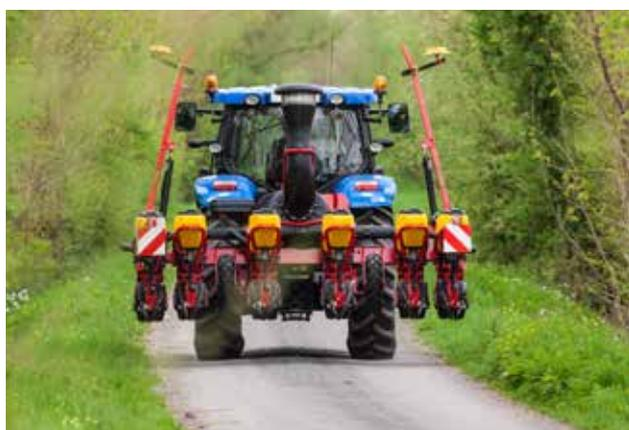
*La largeur de transport du Tempo T est comprise entre 3,3 et 3,5 mètres. Cela permet un faible angle de braquage et un transport simple.*
