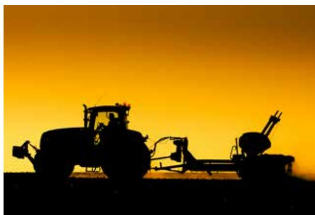
*Un semoir traîné signifie moins de poids sur le tracteur, conduisant à diminuer le compactage du sol. Le bénéfice est une structure de sol saine et une émergence homogène de la culture.*
