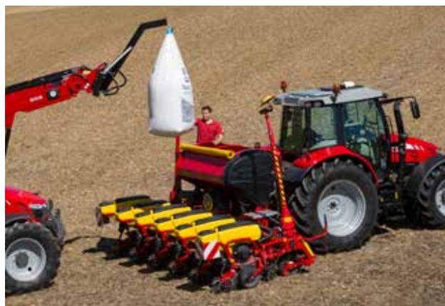
*Le Tempo T peut être équipé d'une trémie à engrais de 1200 litres et d'enfouisseurs.*
