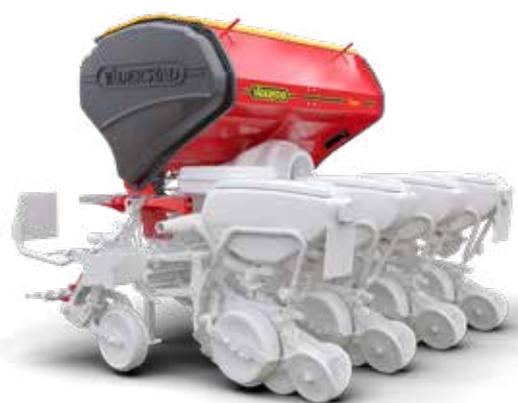
*Le Tempo R peut être équipé d'une trémie à engrais de 1200 litres et d'enfouisseurs d'engrais.*
