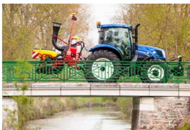
*Le Tempo R de 3 mètres de large est monté sur l'attelage trois points du tracteur, ce qui facilite les manœuvres au champ.*
