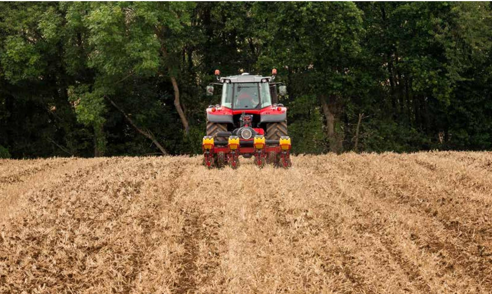
Avec l'espacement des rangs facilement réglable, il est possible de semer de nombreuses cultures avec le même semoir, optimisant l'utilisation de la machine.
