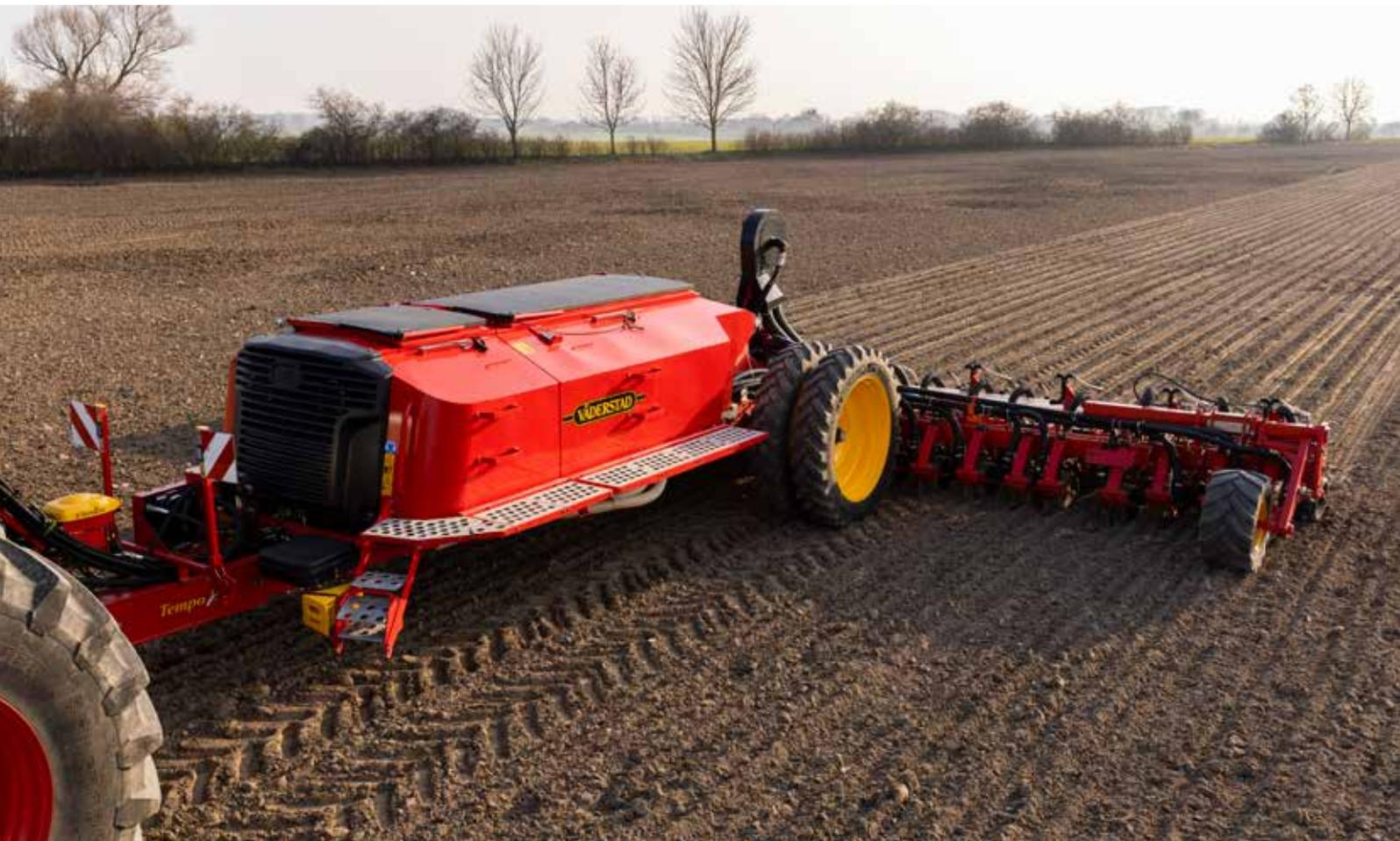
Le Tempo L avec trémie centralisée est conçu avec un objectif clair : augmenter le débit de chantier et la précision du semis. Le système de trémie centralisée est un système pressurisé permettant d'alimenter continuellement les distributions des éléments semeurs du Tempo. Lorsque les semences arrivent aux disques de distribution, la technologie brevetée PowerShoot assure une excellente précision de semis à grande vitesse.
