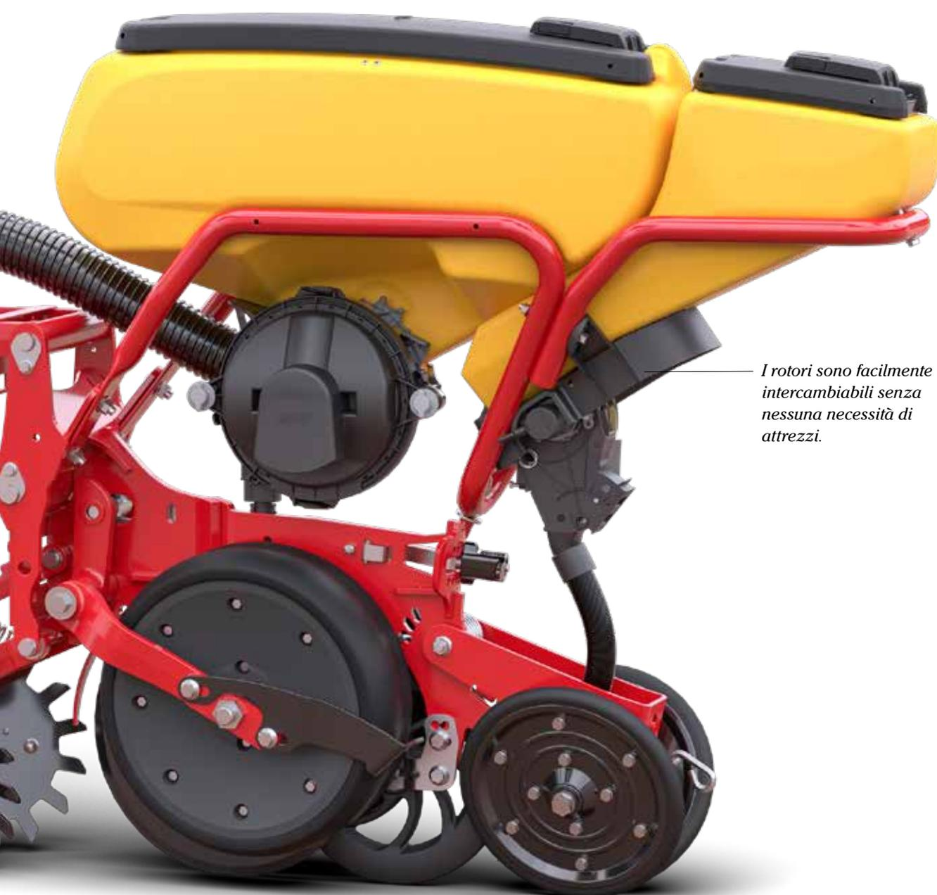
*I rotori sono facilmente intercambiabili senza nessuna necessità di attrezzi.*
