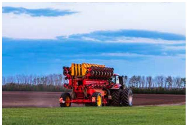
*Nonostante la sua enorme capacità in campo, Tempo L si chiude a 3 metri di trasporto stradale.*
