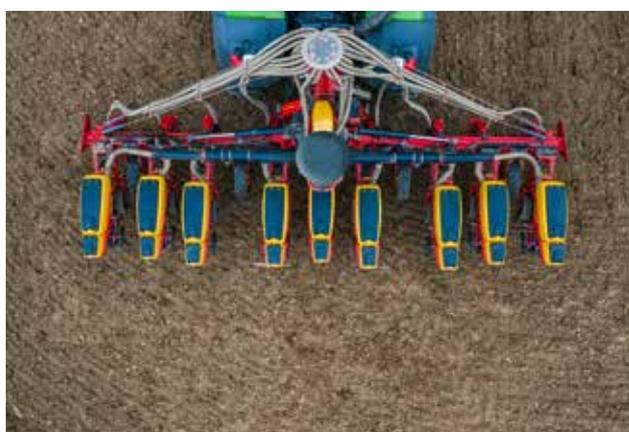
*WideLining adatta automaticamente la spaziatura delle righe alle tracce delle ruote dello spanditore di letame liquido, senza ridurre il numero di semi piantati sul campo.*
