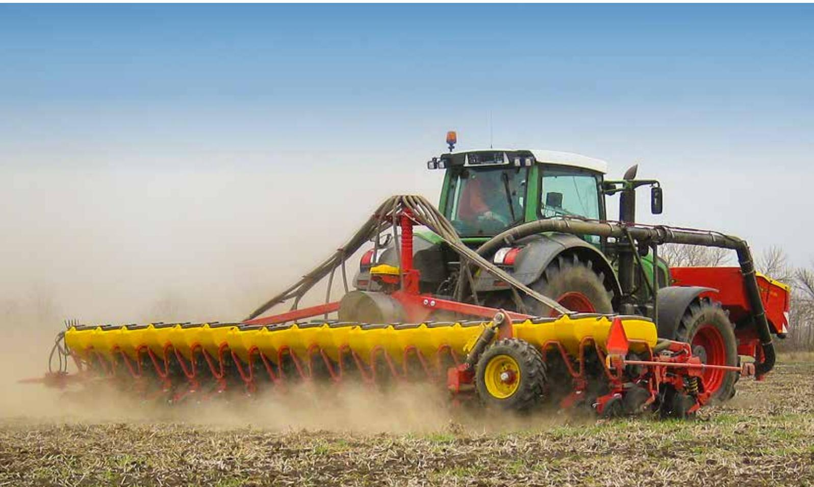
L'attacco a tre punti provvede una manovrabilità eccellente e testate corte, addizionalmente, un telaio rigido beneficia di poche parti mobili, peso minimo e manutenzione ridotta senza compromettere l'eccellente precisione che la Tempo R offre.
