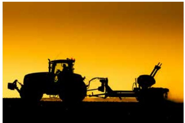
*Una seminatrice trainata comporta meno peso sul trattore, portando a una compattazione del terreno minima. I benefici di questo sono una struttura del terreno salutare e una emergenza della coltura uniforme.*
