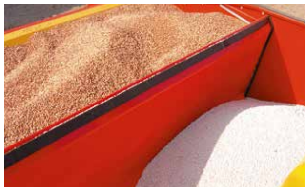
Rapid 300-400C/S ir aprīkota ar lielas ietilpības sēklas tvertni. Kombinētajiem modeļiem attiecību starp sēklu un mēslojumu var viegli mainīt.
