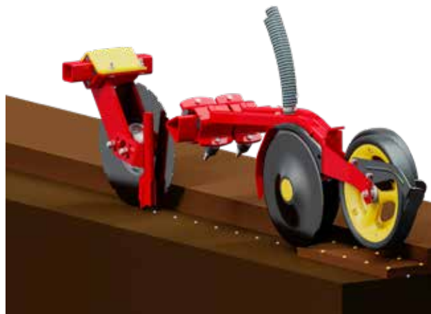
Med Nordic metoden placeres gødningen med en rækkeafstand på 250mm mellem to rækker såsæd for fuld adgang til fugtigheden.
