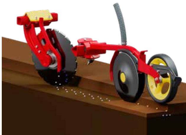
FIX versionen placerer gødningen i 5cm brede striber med en rækkeafstand på 125mm foran hver sårille.
