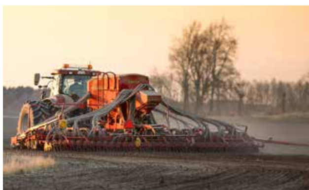
Para optimizar el rendimiento en el campo, Spirit 600-900C está equipada con el cierre de la mitad de la máquina, tanto para las semillas como para el fertilizante.
