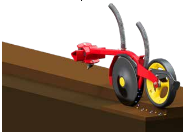
La versión en línea coloca el fertilizante en una salida separada junto con las semillas en el disco de siembra.
