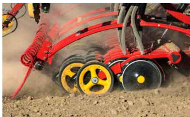
La presión de los discos de siembra, la intensidad de trabajo de las herramientas delanteras o la presión ejercida por la rastrilla trasera se ajustan fácilmente sobre la marcha desde la cabina.
