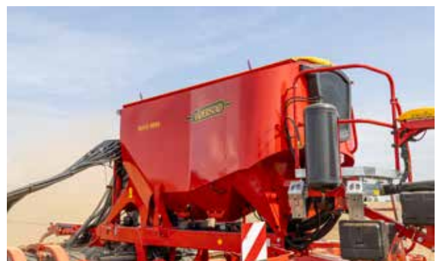
El modelo Spirit 600-900S sólo para semillas tiene capacidad para 5000 litros.
