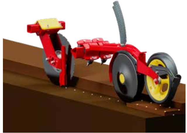
Nordic-järjestelmässä lannoite sijoitetaan 25 cm riviväleihin kahden siemenrivin väliin, jolloin maan kosteus päästään täysin hyödyntämään.
