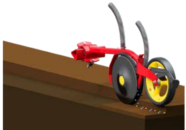
InLine-versiossa sijoittaa lannoite sijoitetaan oman vantaan kautta, mutta samaan uraan siemenvantaan kautta kulkevien siementen kanssa.
