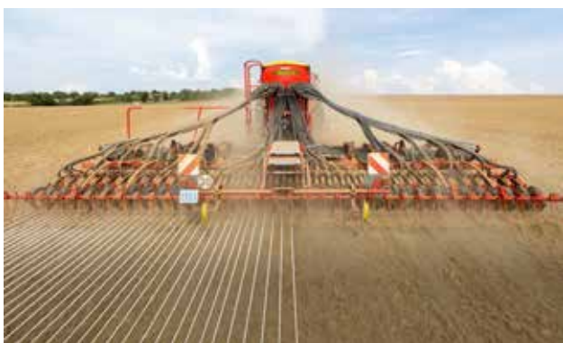
Spirit 600-900S -malleissa puolen koneen sulku onnistuu suoraan ohjaajan penkiltä.
