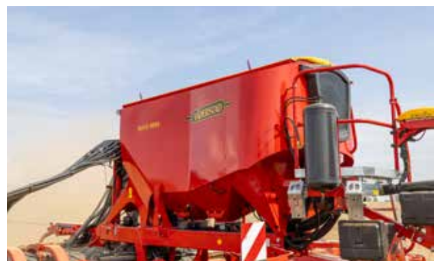
Pelkille siemenille tarkoitetun Spirit 600-900S -mallin säiliön tilavuus on 5000 litraa.
