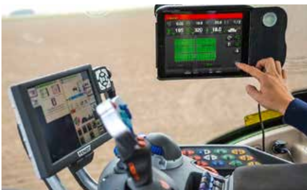
Syötön hoitaa kaksi Fenix III -yksikköä, puoli konetta kumpikin, joten puolen koneen sulku onnistuu ohjaamosta.
