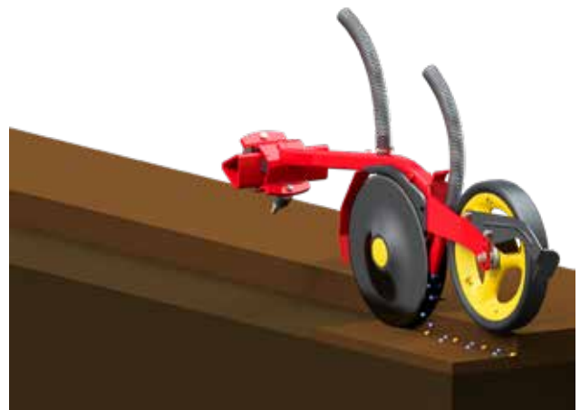
Az InLine rendszer a műtrágyát a maggal együtt, de attól elkülönítve juttatja el a vetőcsoroszlókhoz.
