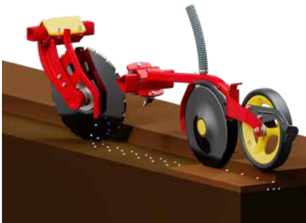
FIX versija iestrādā mēslojumu 5 cm platās strīpās ar 125 mm rindstarpu atstatumu katras sēklu rindas priekšā.
