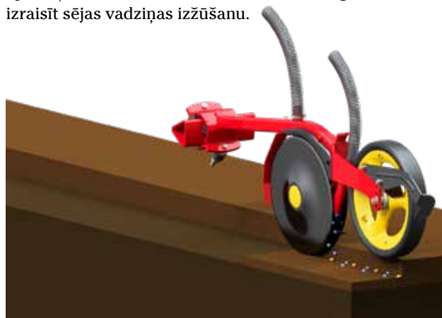
InLine versijā mēslojums kopā ar sēklām nonāk sēklas iestrādes nonāk sējas lemesītī.
