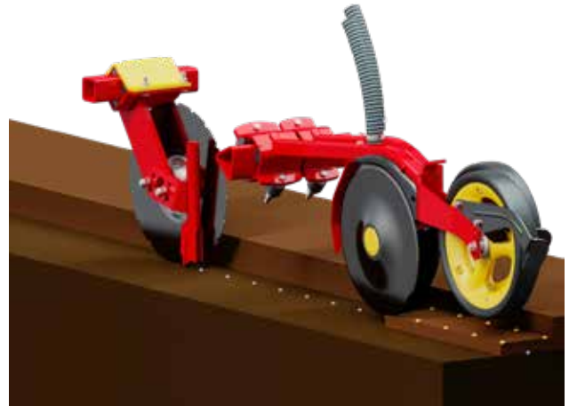
Met de Nordic-uitvoering wordt kunstmest met rijafstanden van 250 mm tussen twee rijen zaad afgelegd, waar het goed toegang tot het bodemvocht heeft.
