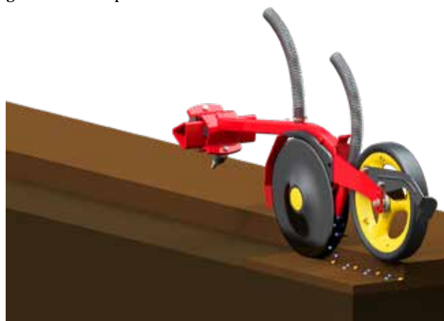
Versiunea InLine plasează fertilizatorul într-o intrare separată împreună cu semințele în brazdă de semințe.
