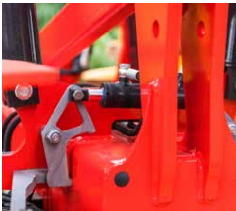
Carrier XT се управлява лесно от кабината, включително хидравлично заключване на страничните секции.
