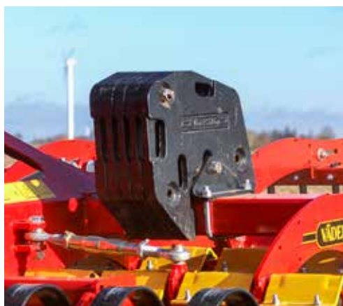
Carrier 300-400 може да бъде оборудван с допълнителни тежести.
