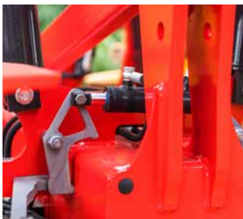
Carrier XT se snadno ovládá z kabiny, včetně hydraulického zámku křídel.
