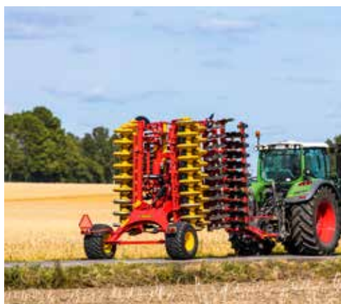
Při přepravě stroje Carrier XL 425-725 mezi poli se jeho křídla složí na přepravní šířku 3 m.
