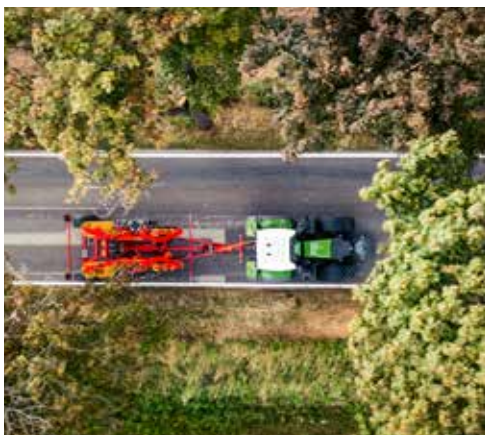
Die angehängte Carrier XT ist für den Straßentransport mit einer Geschwindigkeit von 40 km/h zugelassen.
