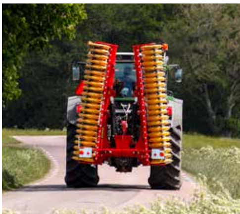
Die Transportbreite der montierten Carrier XT beträgt nur 2,4m.
