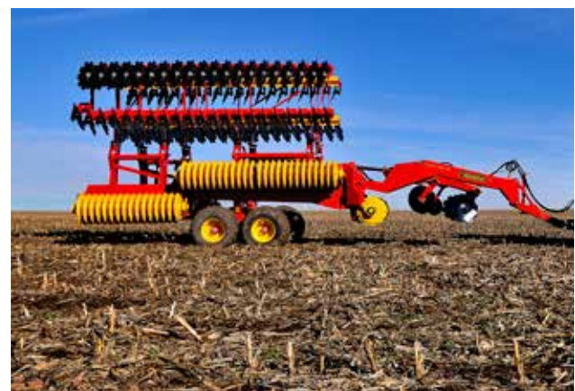
Dank der einzigartigen Klappung besitzt Carrier XL 925-1225 einen niedrigen Schwerpunkt, gute Manövrierfähigkeit beim Transport sowie eine hervorragende Konturanpassung im Feld.
