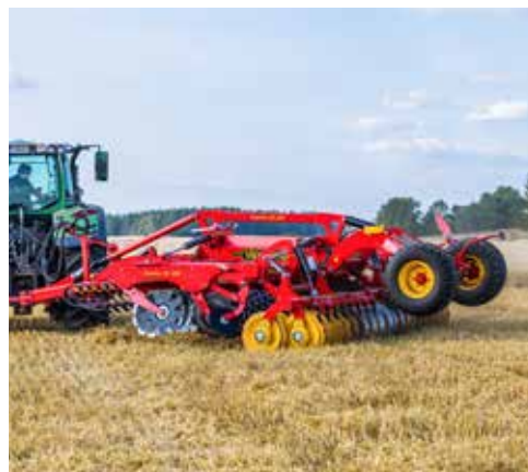
Am Vorgewende kann die Maschine entweder auf der Walze oder auf den Rädern gewendet werden.
