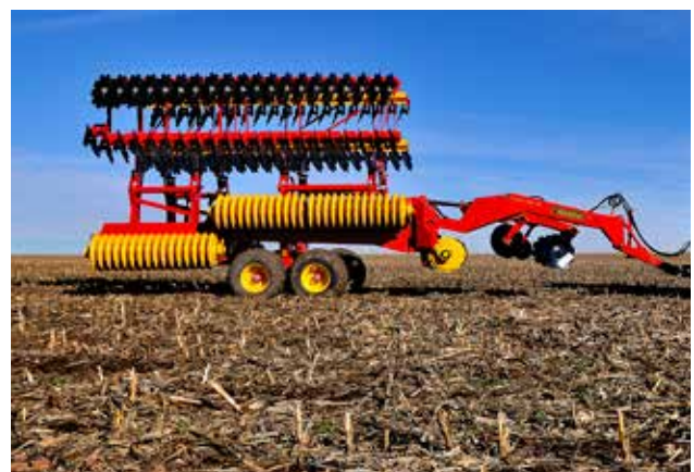
Den unikke foldning giver Carrier XL 925-1225 et lavt tyngdepunkt og gode manøvreevner under transport samt fremragende jordfølgen i marken.
