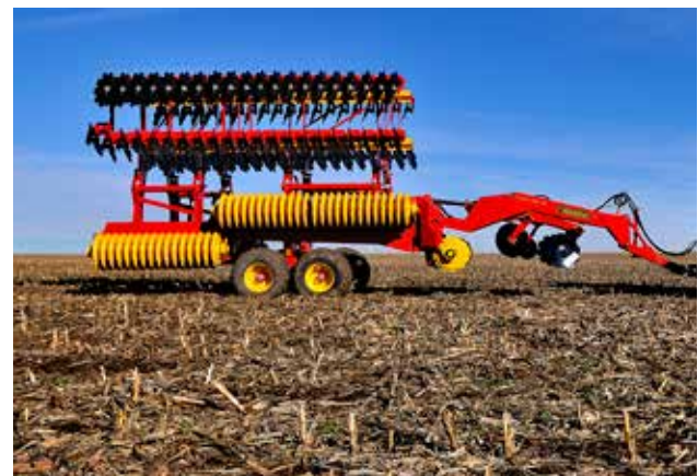
El plegado exclusivo le proporciona al Carrier XL 925-1225 un centro de gravedad bajo y una buena maniobrabilidad en el transporte, así como un excelente seguimiento del contorno en el campo.
