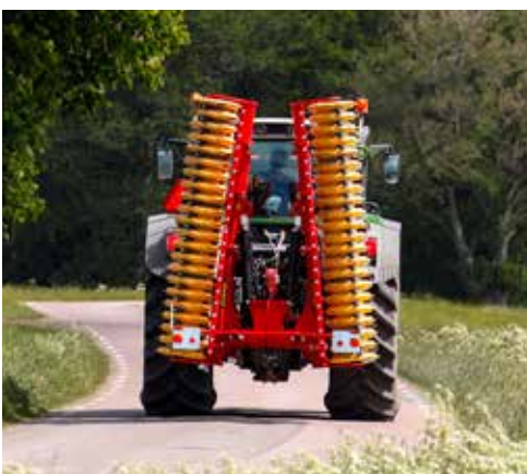
La anchura de transporte de Carrier XT (suspendido) es de solo 2,4 m.
