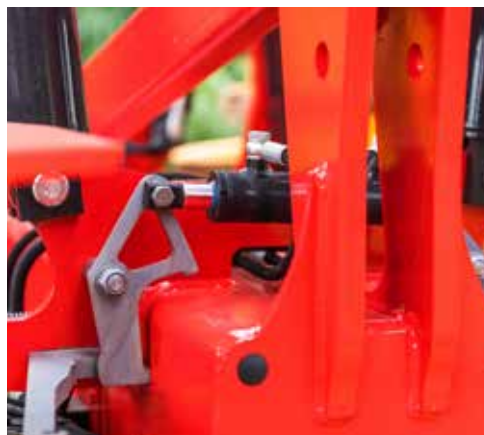
Carrier XT se controla fácilmente desde la cabina e incluye bloqueo de alas hidráulico.
