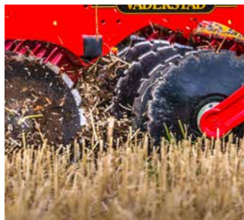
Kaks rida tugevdatud Roots'i V55 teraskettaid töötavad kuni 12 cm sügavuselt.
