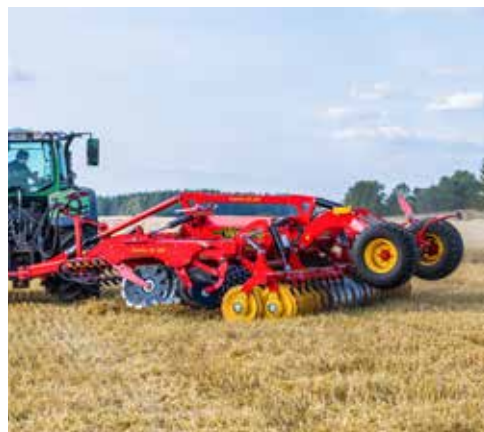
Põllul saab masinat pöörata kas tihendusrullil või veermikul.
