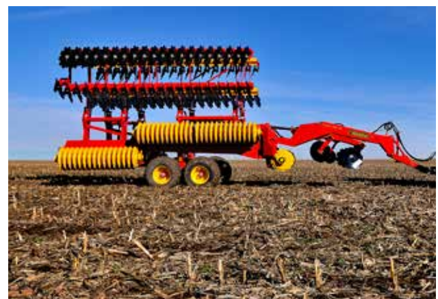
Ainutlaatuisen taittojärjestelmän ansiosta Carrier XL 925-1225 -muokkainten painopiste on alhaalla ja siksi niiden kuljettaminen on sujuvaa. Lisäksi ne myötäilevät pellon pintaa erinomaisesti.
