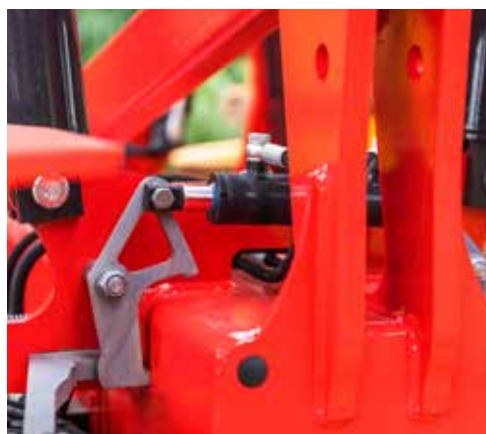
Carrier XT -mallia on helppo ohjata ohjaamosta, ja siinä on hydraulinen sivulohkolukitus.
