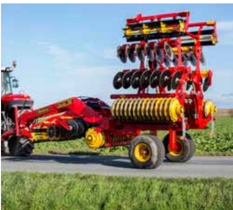
Le repliage unique donne au Carrier 420-820 un centre de gravité bas et une bonne stabilité lors du transport, ainsi qu'un excellent suivi du relief des parcelles.
