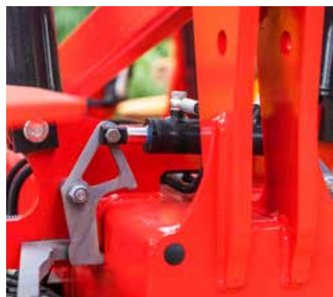
Le Carrier XT est facile à gérer depuis la cabine, et équipé d'un dispositif de verrouillage hydraulique des sections latérales.
