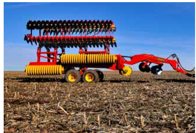
Le repliage unique donne au Carrier 925-1225 un centre de gravité bas et une bonne stabilité lors du transport, ainsi qu'un excellent suivi du relief des parcelles.
