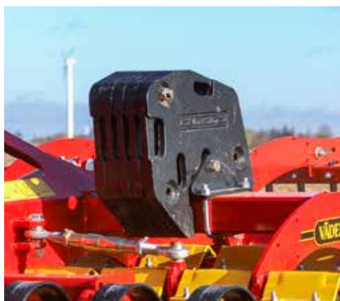
Carrier 300-400 može biti opremljen sa dodatnim paketima utega što rezultira težinom stroj do 800kg/m.
