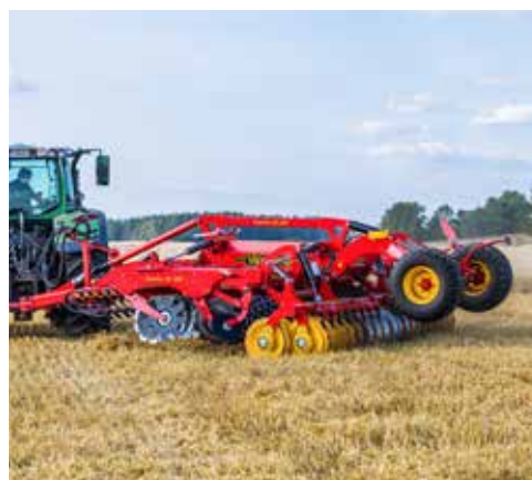
Na uvratinama stroj se može okretati ili na packer valjku ili na kotačima.
