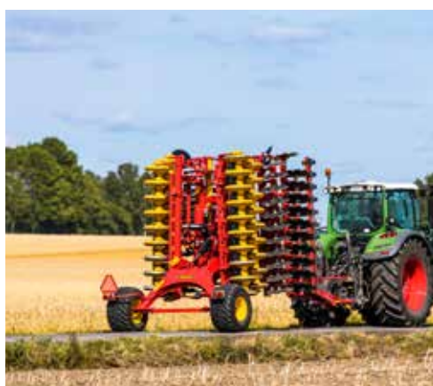
Kod transporta Carrier XL 425-725 između polja, stroj se sklapa na krilnim sekcijama kako bi ostao unutar 3m transportne širine.
