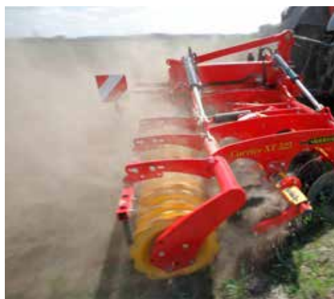
Az erős csövázzal és nagy teherbírású kötésekkal a Carrier XT ellenáll a nagy igénybevételnek.
