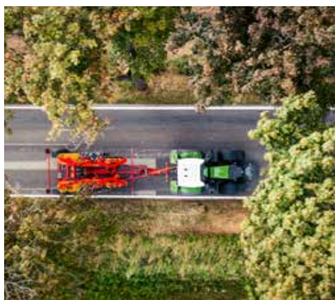
A vontatott Carrier XT 40 km/h sebességű közúti szállításra engedélyezett.
