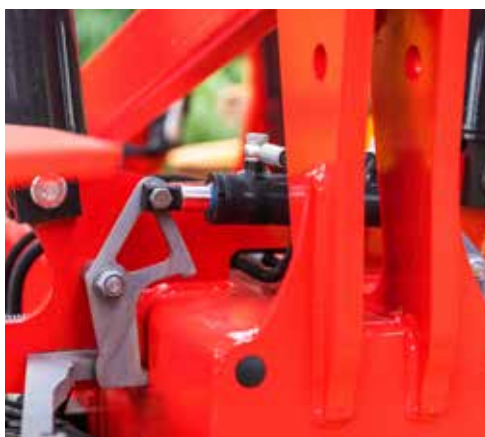
A Carrier XT könnyen vezérelhető a vezetőfülkéből, beleértve a hidraulikus szárnyzárát is.
