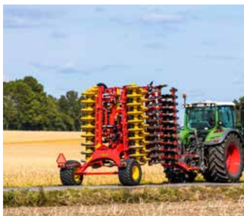
A Carrier XL 425-725 szélessége szállítási helyzetben nem haladja meg a 3 métert.
