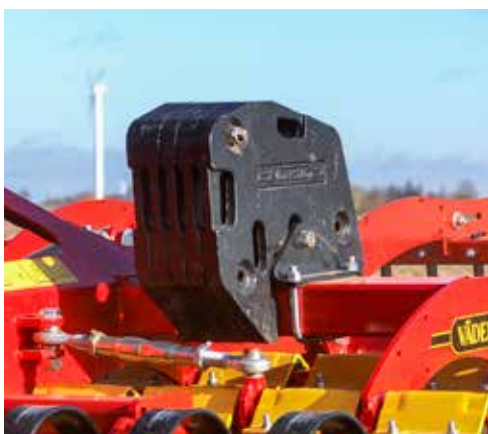
Il Carrier 300-400 può essere fornito di zavorre per aumentare il carico a 800 kg/m.
