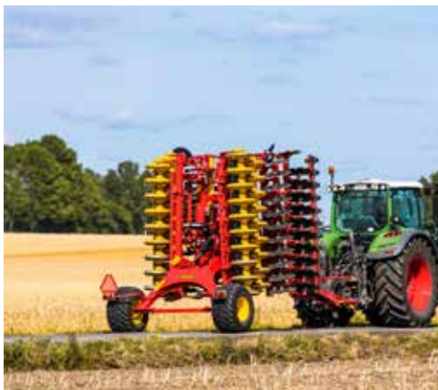
Durante lo spostamento tra gli appezzamenti del Carrier XL 425-725, la macchina viene richiusa per poter rientrare nei 3 m di larghezza per il trasporto.
