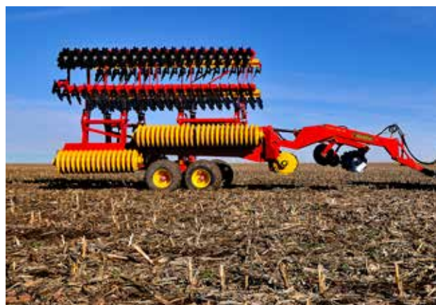
Unikālā sānu sekciju locīšanas sistēma nodrošina Carrier XL 925-1225 zemu smaguma centru un labu manevrētspēju, transportējot, kā arī lielisku lauka reljefa kopēšanu.
