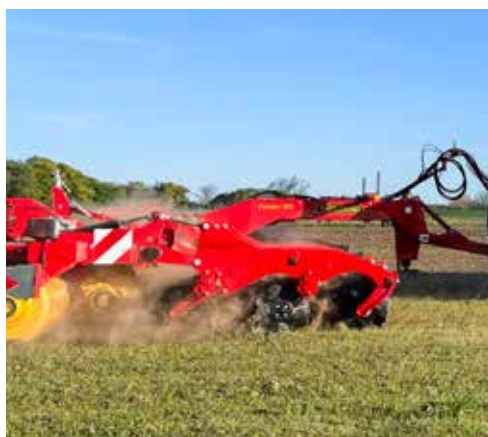
Ar 3 CrossCutter Disc disku rindām aprīkotais Carrier 925 spēj nodrošināt vēl intensīvāku īpaši seklas augsnes apstrādi.
