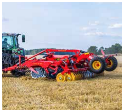
Op de kopakker kan de machine op de pakkerrol of op de wielen worden gezet.
