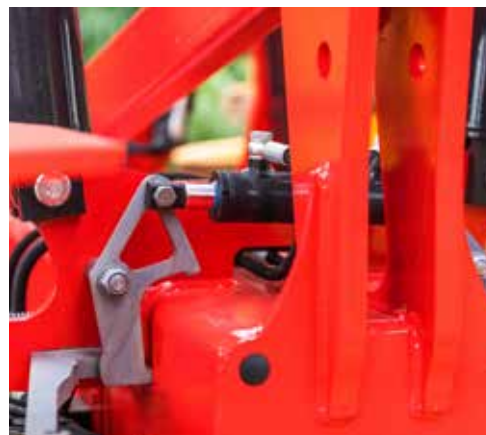
Carrier XT is eenvoudig te bedienen vanuit de cabine, inclusief hydraulische vleugelvergrendeling.
