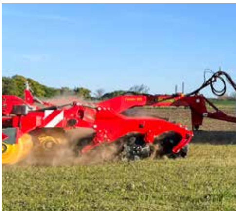
Echipat cu 3 rânduri de discuri CrossCutter Disc, Carrier 925 își mărește și mai mult intensitatea în cazul prelucrării solului la adâncime foarte mică.
