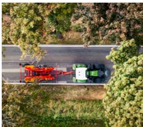
Vučeni Carrier XT je sertifikovan za drumski prevoz pri brzini od 40 km/h.
