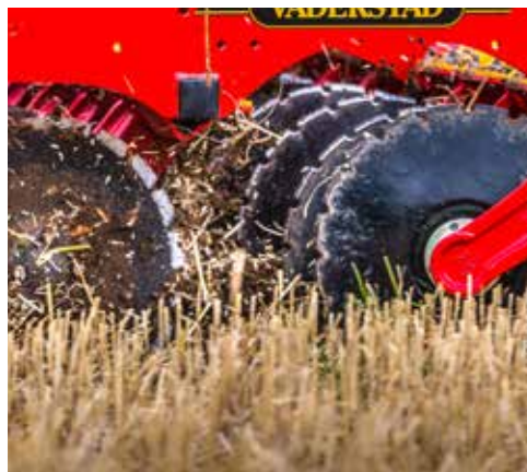
Maskinen har två rader tallrikar av högkvalitativt svenskt V-55-stål, med ett arbetsdjup på upp till 12 cm.
