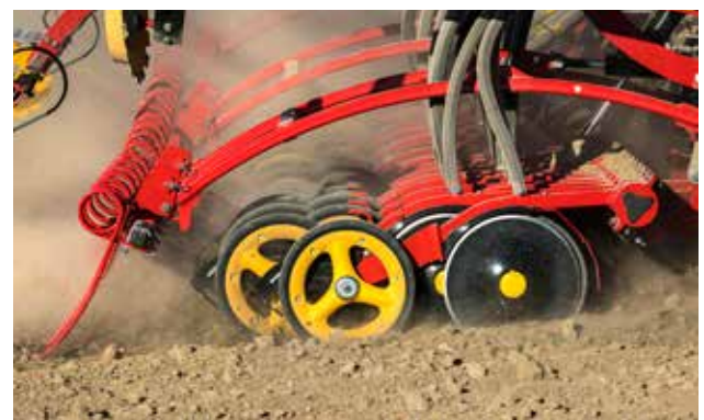
Hydraulisk efterharv och aktivt billtryck reglerbart från förarplats. Ökad lyfthöjd av billaggregat.
