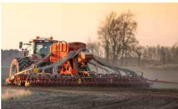
För att optimera Spirit 600-900C i fält är maskinen utrustad med halvmaskinsavstängning på både utsädes och gödningssidan.
