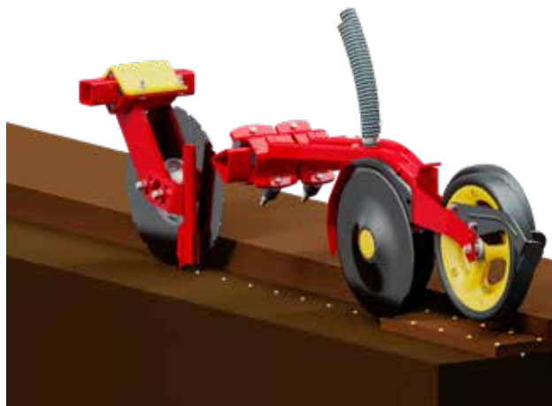
Nordic-versionen placerar gödningen mellan utsädesraderna med 250 mm radavstånd, vilket ger full tillgång till markfukt.
