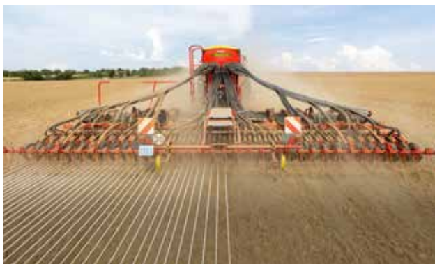
På Spirit 600-900S kan halva maskinen stängas av direkt från hytten.
