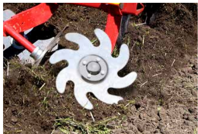
Afin de s'adapter aux différentes conditions de sol, le conducteur peut ajuster hydrauliquement l'intensité des disques niveleurs avec une précision millimétrique, même en mouvement.
