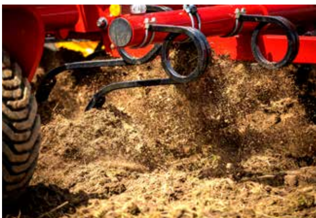
Les dents vibrantes Swift fournissent un mélange intensif jusqu'à une profondeur de travail de 20 cm.
