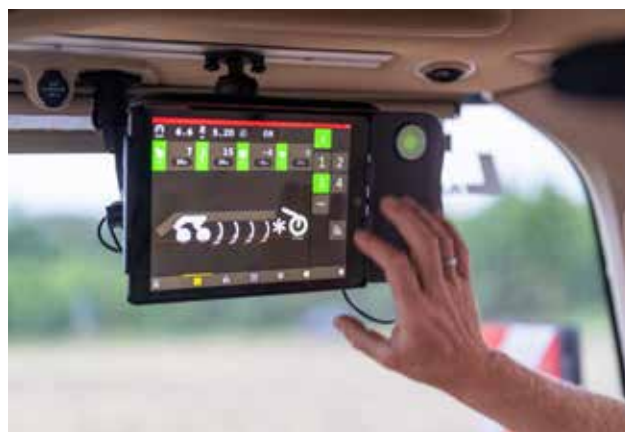
Įrengus „TopDown“ su „iPad“ pagrįsta „E-Control“ sistema, galima visapusiškai valdyti ir sudaryti žemės dirbimo žemėlapius.
