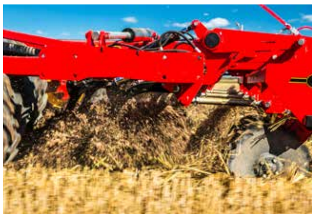
TopDown, atlikdamas keletą darbų vienu metu, gali paruošti kokybišką sėklų guoliavietę vienu važiavimu.
