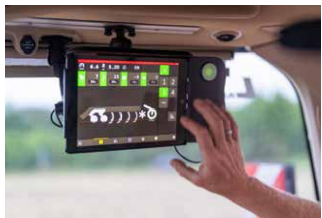
Aprīkojot TopDown ar iPad bāzēto E-Control sistēmu, ir iespējams pilnībā kontrolēt, kā arī veikt augsnes apstrādi pēc priekšrakstiem.
