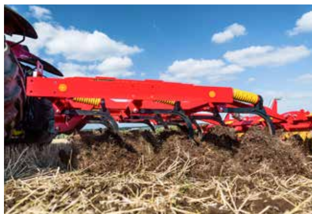
Zęby Cultus i Cultus HD pracują z wysoką wydajnością i przy utrzymaniu stałej głębokości pracy.
