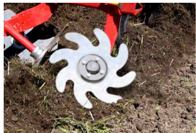
För att kunna anpassa maskinen efter olika jordförhållanden, kan föraren justera intensiteten på de hydrauliska utjämnartallrikarna med millimeterprecision utan att stanna.
