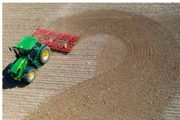
Jedinečná všestranná tažná oj umožňuje otáčení, s NZ Mounted v pracovní poloze.
