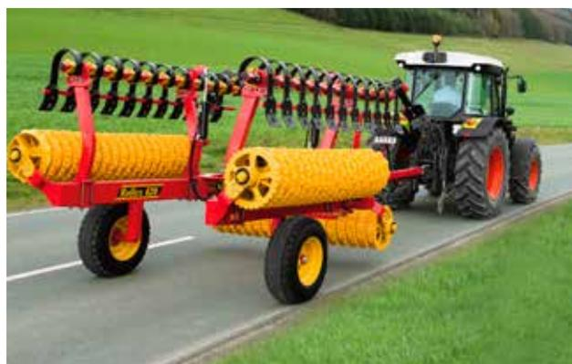
*Para permitir que el transporte entre campos, Rollex pliega a 2,8 metros de anchura de transporte.*
