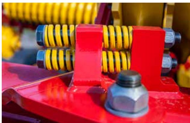
*Pesados resortes transfieren el peso para asegurar una carga uniforme en todas las secciones de la máquina.*
