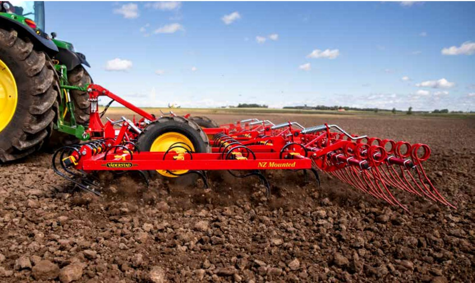
Los dientes AgrillaNova montados sobre cuatro ejes junto a un espaciamiento de 9 cm permite una preparación intensiva del lecho de siembra.
