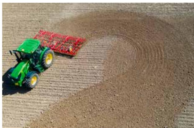
*La exclusiva y versátil barra de tracción permite girar, con NZ Mounted en posición de trabajo.*
