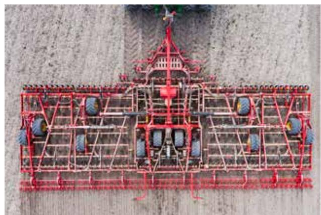
*Las anchas ruedas de apoyo del bogie OffSet transportan NZ Extreme y mantienen la profundidad de trabajo.*
