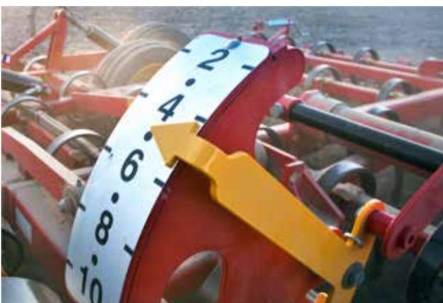
Con ControlFunction es posible ajustar la profundidad de trabajo según las condiciones del suelo desde la cabina y en movimiento.
