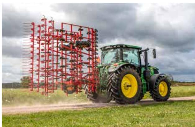
*NZ Mounted pliega a 2,05 metros anchura de transporte, asegurando un transporte cómodo entre los campos.*
