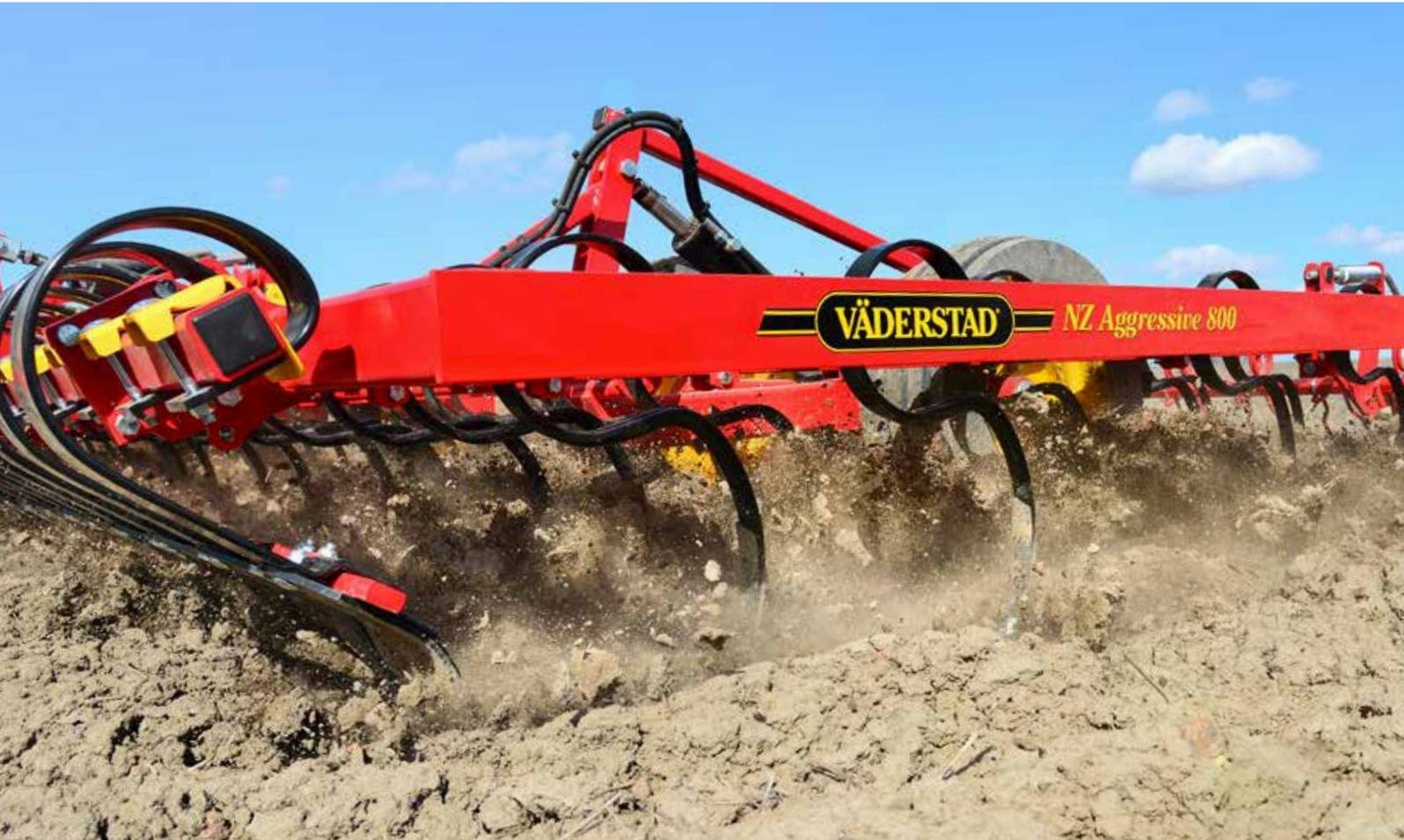
NZ Aggressive tiene un CrossBoard de nivelación seguido de dientes con un espaciado de 7,5 cm, distribuido en 5 o 6 ejes. Usted se beneficiaría de una máquina con gran capacidad de trabajo, que proporciona una profundidad de trabajo constante y permite una entrada temprana en el campo.
