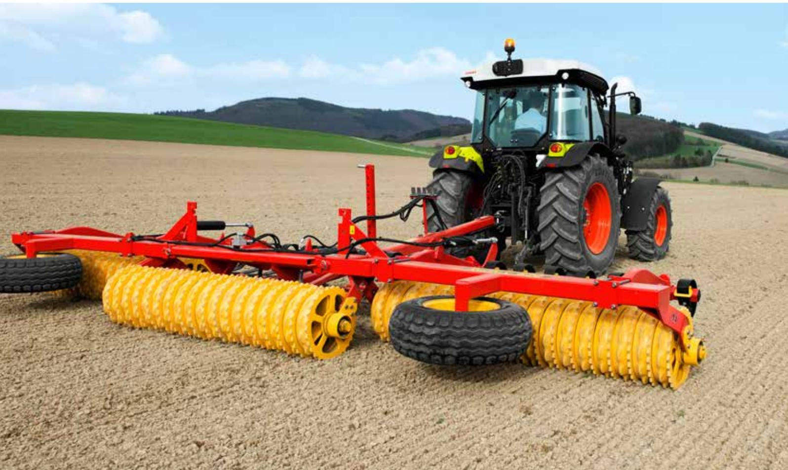
Rollex tiene un bastidor fuerte, ejes endurecidos y anillos de rodillo de alta calidad, asegurando una larga vida útil. Los ejes de los rodillos están hechos de acero especial micro-aleado de la más alta calidad. Para reducir al mínimo el desgaste del anillo en el campo, Rollex está equipado con arandelas elásticas entre las secciones de rodillos.
