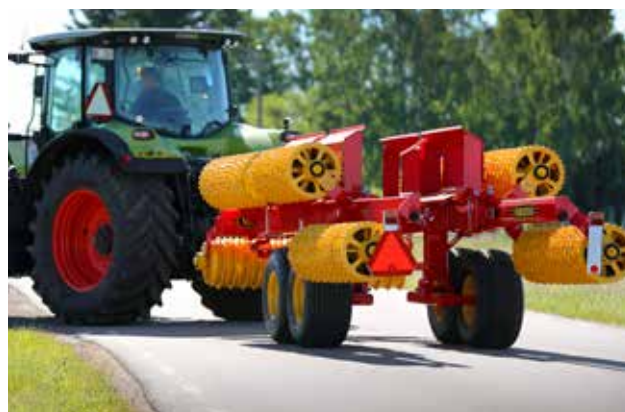
Masina kokkklapitamise tehnika vähendab raskusjõudu masina keskel, mis teeb Rollex'i transportimise turvaliseks. Vaatamata Rexius'e suurele töölaiausele on selle transpordilaius vaid 2,5 meetrit.
