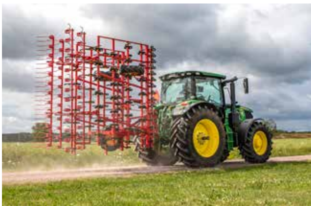
Siirtoajoa varten NZM taittuu mukavaan 2,05 metrin kuljetusleveyteen.
