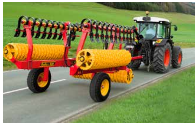
Siirtoajoa varten Rollex taittuu mukavaan 2,8 metrin kuljetusleveyteen.
