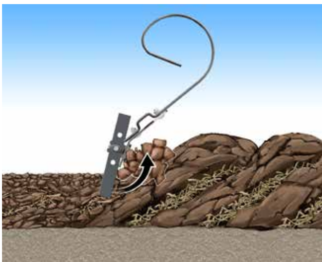
En plus du sillon, le SingleKnife alimente la CrossBoard avec plus de matière, ce qui favorise la création de terre fine.
