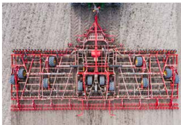
Široki OffSet potporni kotači nose NZ Extreme i osiguravaju radnu dubinu.
