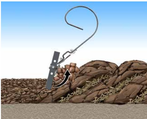
Uz rezanje brazde, SingleKnife noževi hrane CrossBoard lopatice sa dodatnim materijalom, čime se dodatno pospešuje stvaranje fine pripreme.
