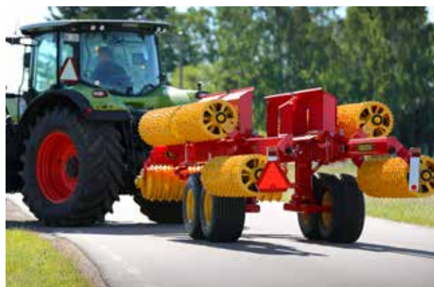
Il sistema di chiusura del rullo abbassa il centro di gravità, rendendo ancora più sicuro il trasporto. Nonostante la grande dimensione di lavoro, il Rexius misura 2.5 m nel trasporto su strada.
