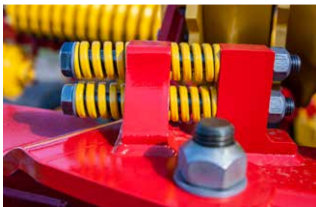
Le grosse molle trasferiscono il carico per assicurare un uniforme peso su tutte le sezioni della macchina.
