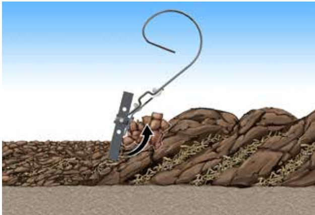
Papildus aruma vagas sagriešanai, SingleKnife sagatavo šļūcei CrossBoard vairāk augsnes materiāla, tāpēc tiek sagatavota vēl smalkāka augsnes virskārta.
