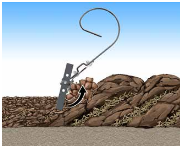
Papildus aruma vagas sagriešanai, SingleKnife sagatavo šļūcei CrossBoard vairāk augsnes materiāla, tāpēc tiek sagatavota vēl smalkāka augsnes virskārta.
