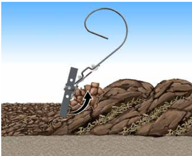
Pored usitnjavanja nakon oranja, SingleKnife doprema do CrossBoard više materijala, dodatno pojačavajući formiranje finog obrađenog sloja.
