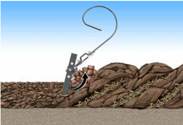
Pored usitnjavanja nakon oranja, SingleKnife doprema do CrossBoard više materijala, dodatno pojačavajući formiranje finog obrađenog sloja.
