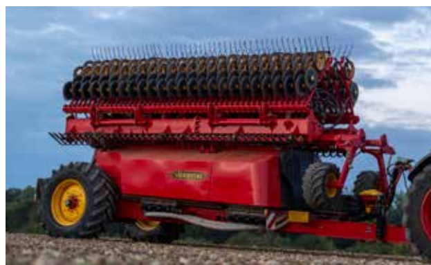
Ve složeném stavu má Inspire 1200C/S šířku 3 metry, což usnadňuje jeho přepravu.
