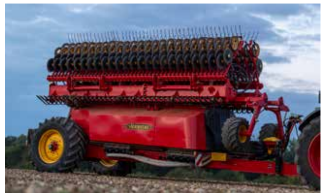
Zusammengeklappt ist die Inspire 1200C/S nur 3 Meter breit, was den Transport vereinfacht.
