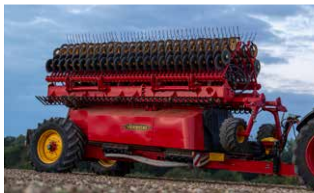
Salocītā stāvoklī Inspire 1200C/S platums ir 3 metri, kas vienkāršo transportēšanu.
